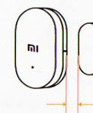
Во время установки, постарайтесь максимально выровнять уровень расположения основного датчика и магнита по специальной отметке
